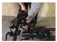
車両の右側に立ち、右グリップとサドル先端を持って、 ハンドルを少し捻るようにしてマグネットを外し、前 輪を滑らすように前に押し出します
